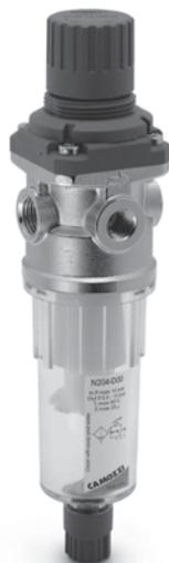
El filtro-regulador de la Serie N se suministra con conexiones de G1/8 y G1/4. El regulador es del tipo de membrana con Relieving, el vaso del filtro es transparente permite ver fácilmente los niveles de la condensación. La descarga semiautomática facilita la expulsión de la condensación manual o automáticamente a falta de presión.
