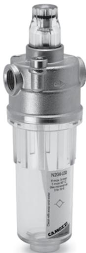
El lubricador de la Serie N se suministra con conexiones de G1/8 y G1/4. Su peculiar tipo de construcción permite una vasta gama de utilizaciones en relación al número de gotas de aceite nebulizado y del aire utilizado. El cuerpo del lubricador es de latón OT58 mientras que el vaso es en tecnopolímero transparente.
