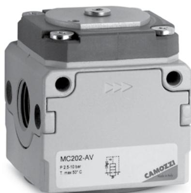
La válvula de apertura progresiva se utiliza para evitar daños a personas o cosas cuando se presurice una instalación neumática. Las características de este componente permiten conseguir la presurización de una instalación de forma progresiva hasta el 50% de la presión programada, alcanzando seguidamente el 100 % se alcanza en un tiempo reducido.
