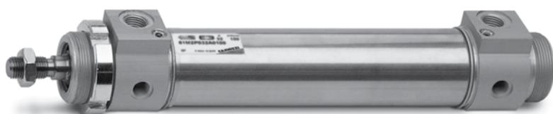
Los cilindros de la Serie 42 se realizan sin tirantes para conseguir un diseño limpio. Para su realización se usa acero INOX para tubo y vástago, mientras que las culatas son de aluminio anodizado. Esta serie de cilindros se suministra normalmente con amortiguadores de fin de carrera regulables por medio de un tornillo alojado en los cabezales. A fin de reducir el ruido provocado por el impacto del émbolo contra el cabezal, estos cilindros van equipados también con un amortiguador mecánico.
